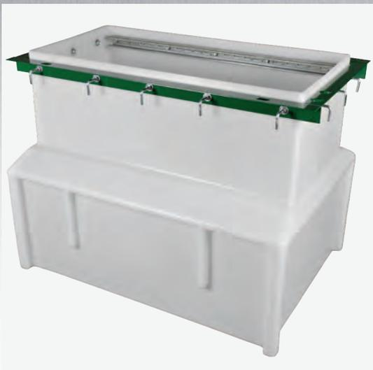
Технологические приямки UPP выполнены из жесткого 8 мм полиэтилена высокой плотности со встроенными, усиленными отливами для установки в таких сложных условиях как движение грунта или избыточные гидростатические нагрузки. Горловина приямка UPP может быть подогнана под глубину технологической части АЗС путем обрезания выступающей части.
